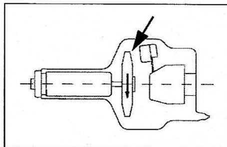
Figure 1: Sens de rotation de l'anode
